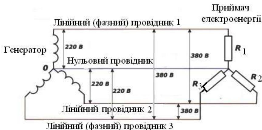
Рисунок 4.9 – Фазні та лінійні напруги трифазної електричної мережі
