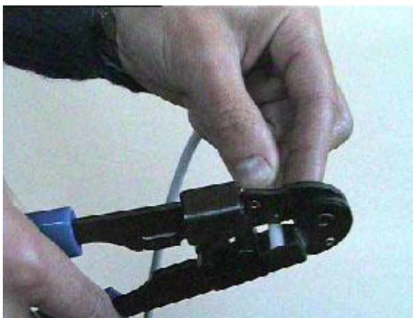
Рис. 7. Зачистка зовнішньої ізоляції
