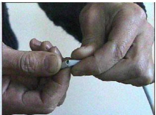
Рис. 8. Видалення зовнішньої ізоляції
