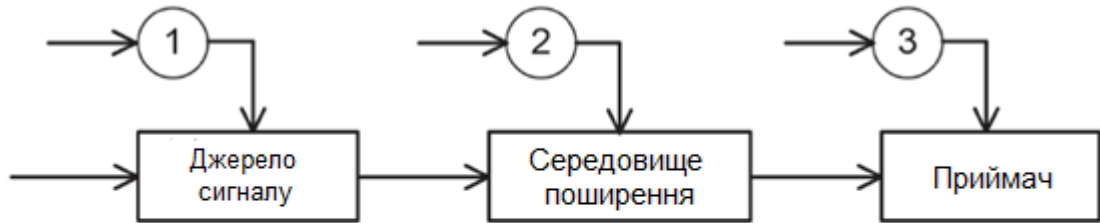
Рис.4 Схема системи передачі інформаційного сигналу з впливами зі сторони навколишнього середовища:
