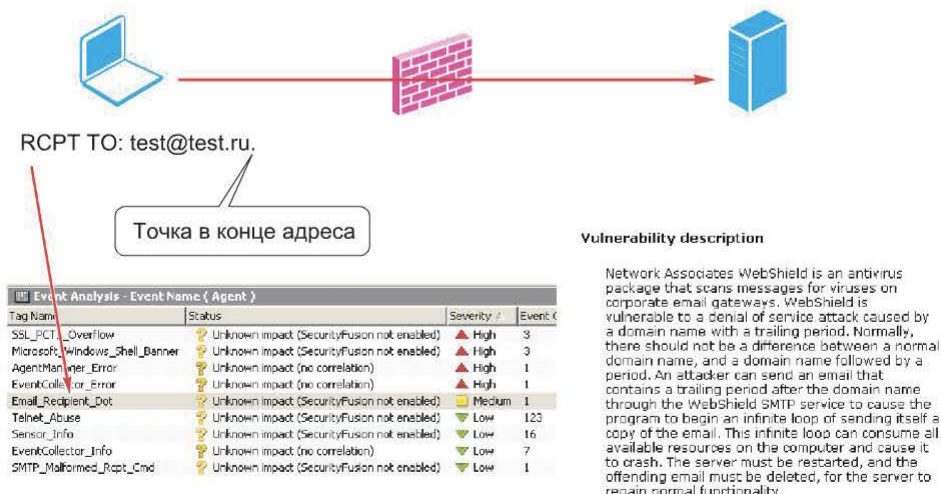
Рис. 22.3. Сигнатура для обнаружения уязвимости CVE-2000-0738
