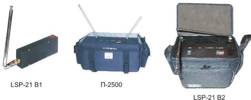
Рис. 25.5. Устройства генерации ради шума
