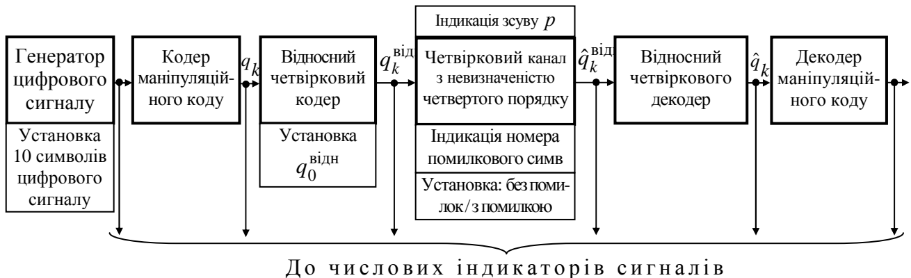
Рисунок 4 – Схема макета для вивчення четвіркового відносного кодування
