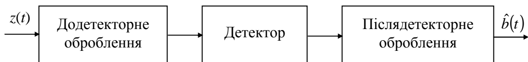
Рисунок 1 – Структурна схема оброблення сигналів у приймачі
