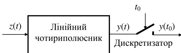
Рисунок 4.1 – Увімкнення чотириполіусника і дискретизатора
