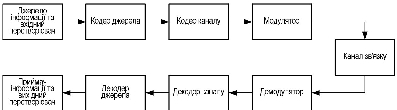
Рисунок 2.1 – Узагальнена структурна схема системи передачі інформації
