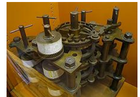
Модель вычислительной части разностной машины Чарльза Бэббиджа
