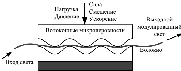
Рис. 7.35. Волоконнооптический датчик неровностей
