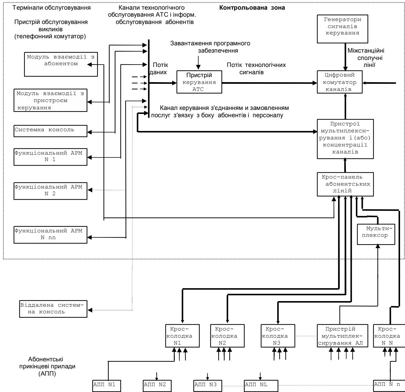
**Рисунок 1 - Структурна схема програмно-керованої АТС з позиції ТЗІ**
