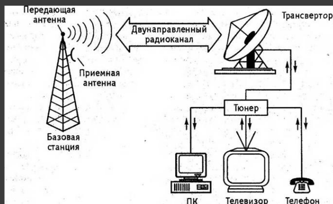
Рис. 5.3. Функциональная схема двунаправленной радиосистемы широкополосного доступа
