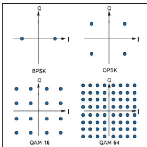
**Рис. 1. Варианты отображения бит на фазовую плоскость**
