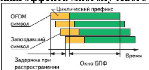
**Рис. 4. Обработка OFDM-символа при многолучевом распространении**
