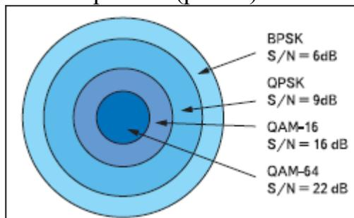
**Рис. 5. Предпочтительный метод модуляции в зависимости от отношения сигнал/шум**
