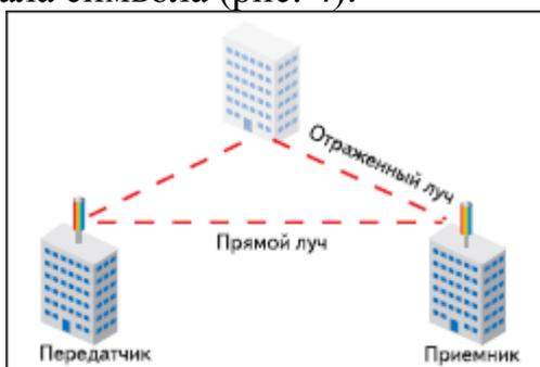
**Рис. 3. Иллюстрация эффекта многолучевого распространения**
