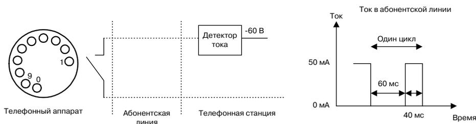
Рис. 1.9 Импульсный набор номера
