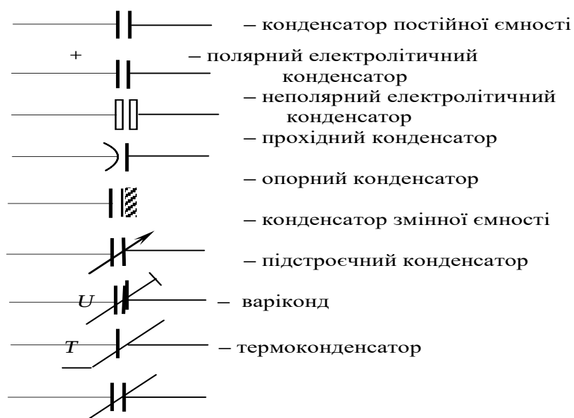
Рис. 1.19 Умовне графічне позначення конденсаторів на принципових електричних схемах
