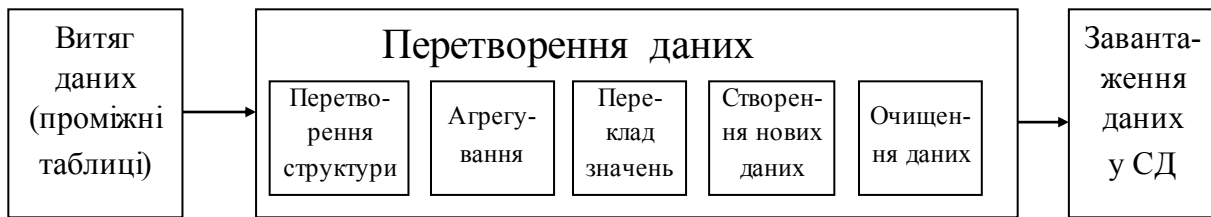
Рис. 2.19. Процес перетворення даних в ETL
