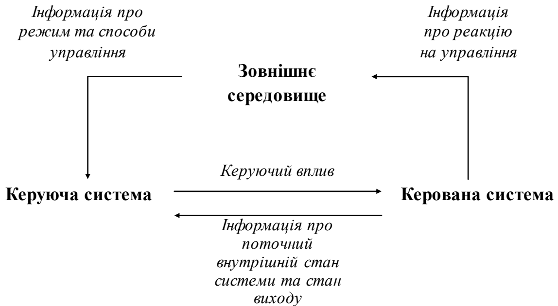
Рис. 1.11. Загальна схема управління системою
