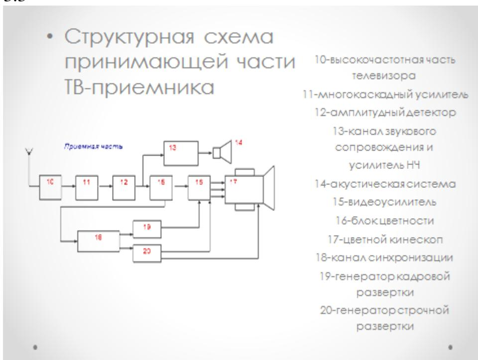
Поэтому в высокочастотной части телевизора 10 осуществляются выбор соответствующего канала, предварительное усиление радиосигналов и их частотное преобразование в промежуточные частоты изображения (38 МГц) и звукового сопровождения (31,5 МГц). Оба сигнала после преобразования усиливаются одним многокаскадным усилителем промежуточной частоты 11, который имеет достаточно широкую полосу пропускания, а затем детектируются амплитудным детектором 12.
